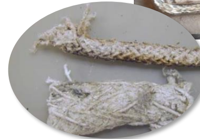
Joint de chaudière
